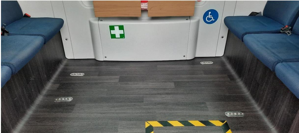
Abbildung 11: Verankerungspunkte für die Rollstuhlsicherung, Quelle: Interlink GmbH
