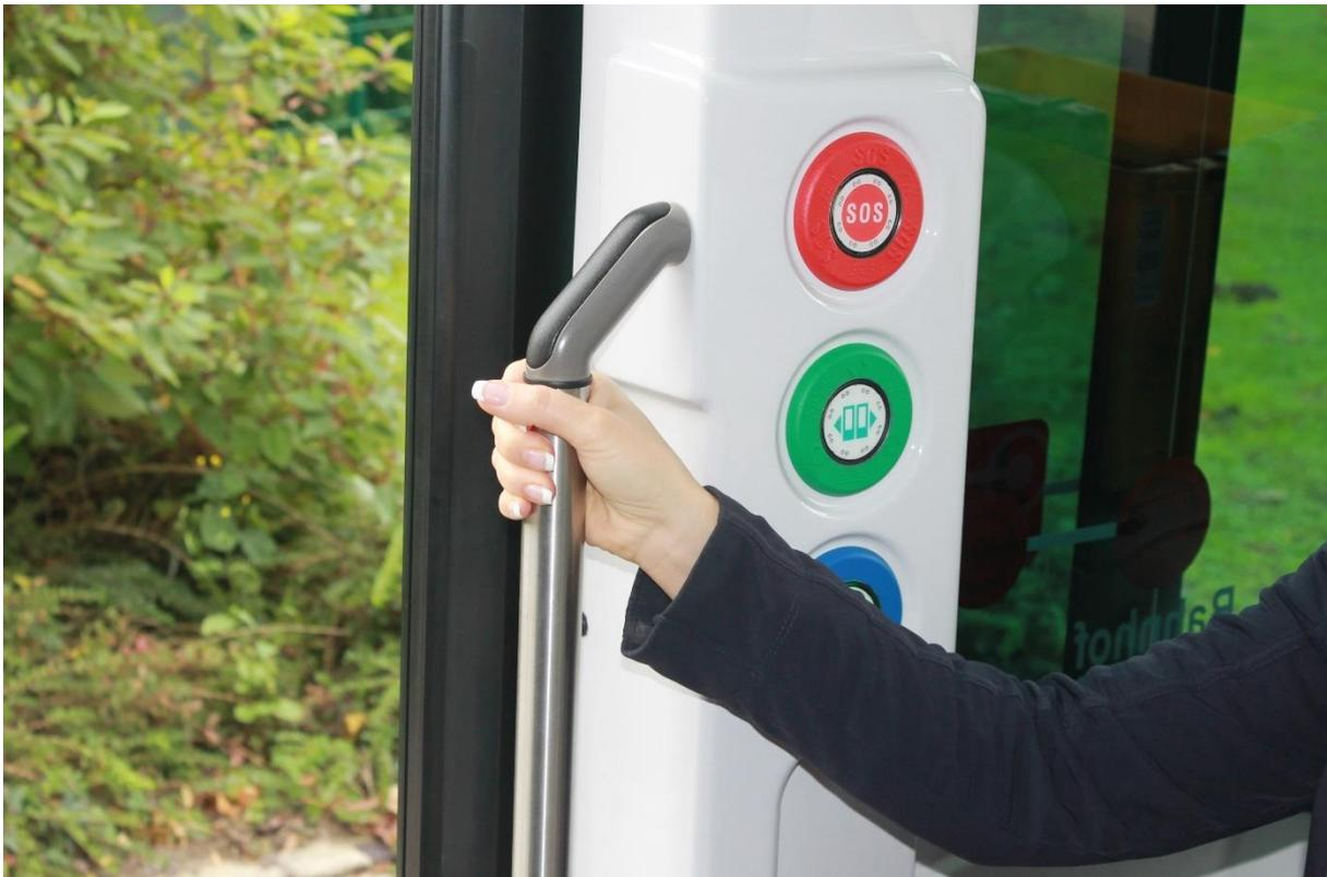
Abbildung 25: Risiko für ungewolltes Auslösen der Taster im Haltestangen-Bereich, Quelle: LWL-Berufsbildungswerk Soest
