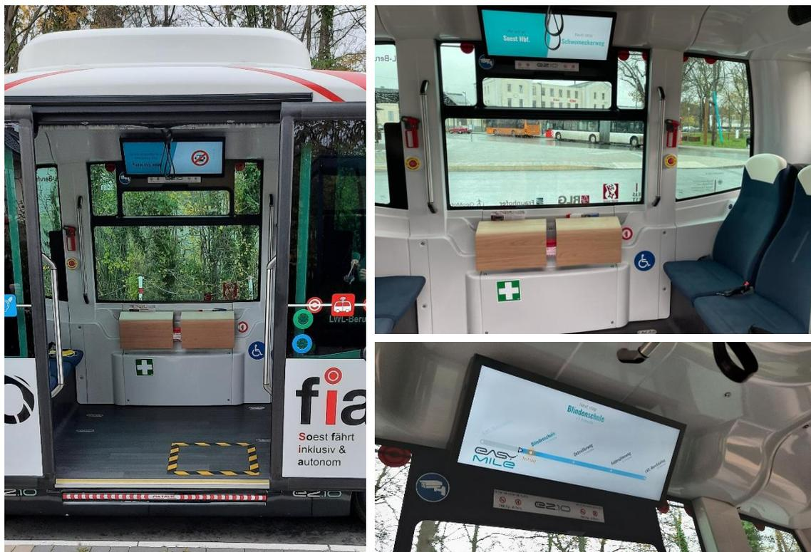
Abbildung 13: Position der Fahrgastanzeige im Fahrzeuginnenraum, Quellen: Interlink GmbH, Kreis Soest
