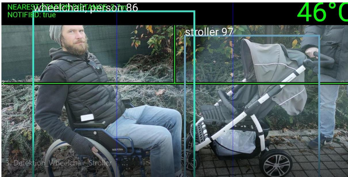
Abbildung 16: Beispiel für die Erkennung eines Rollstuhlfahrers und Kinderwagens an der Haltestelle des LWL, Quelle: Fraunhofer FOKUS
