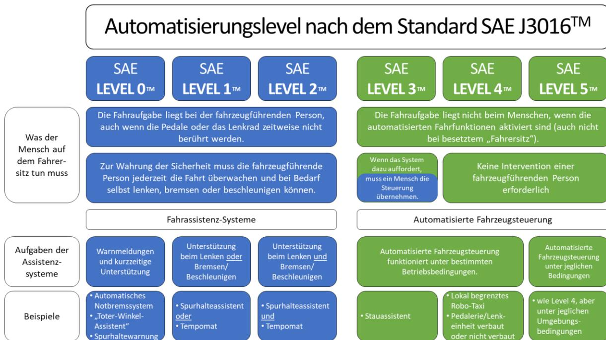
Abbildung 1: SAE J3016™-Level des automatisierten Fahrens, Quelle: eigene Darstellung und Übersetzung nach SAE International (2021)
