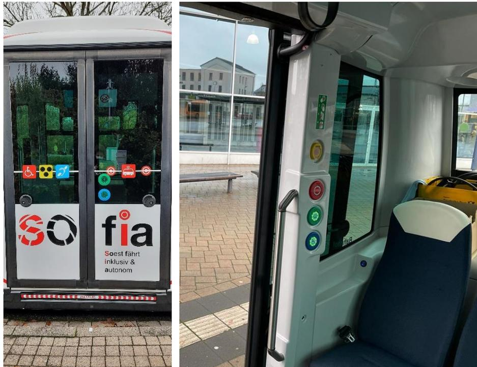
Abbildung 12: Anordnung der Taster mit Ansicht des äußeren Türbereichs (links) und der rechten Seite des Innenraums (rechts), Quellen: Interlink GmbH, Kreis Soest
